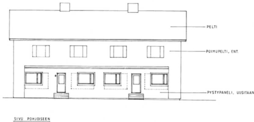
Kuva 54. Aunuksen Liepeentien puoleinen julkisivu. Julkisivumateriaalina on poimupelti lukuun ottamatta pystyaukokuksella verhoiltua seinäpintaa alakerran liiketilöiden kohdalla. (T. Ahola, 2023.)
