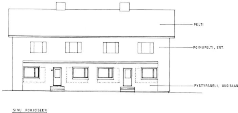
Kuva 54. Aunuksen Liepeentien puoleinen julkisivu. Julkisivumateriaalina on poimupelti lukuun ottamatta pystyauoituksella verhoiltua seinäpintaa alakerran liiketilojen kohdalla. (T. Ahola, 2023.)
