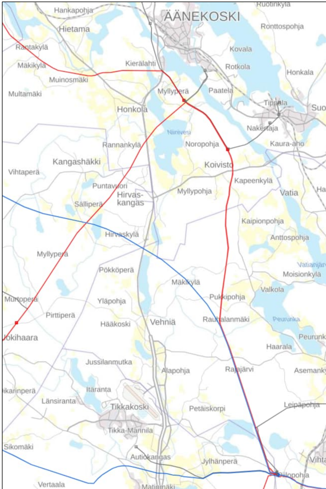
Kuva 5. Ote Suomen kantaverkosta. Kuvassa sinisellä 400 kV voimajohdot ja punaisella 110 kV voimajohdot.
