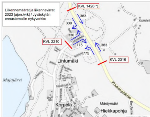
Kuva 19. Nykyverkon liikennemäärät ja liikennevirrat (A-Insinöörit, 2024).
