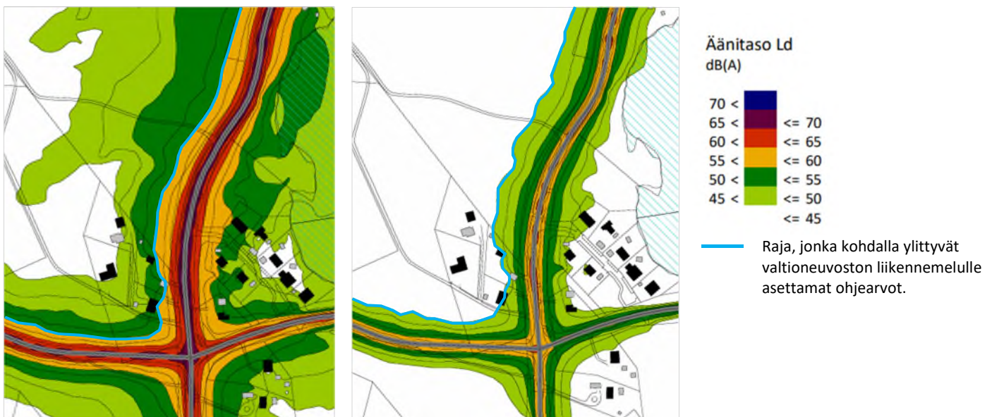
Kuvat 44–45. Meluvyöhykkeet ennusteliikenteellä (v. 2040), tieliikenne, suunniteltu liikenneverkko: vasemmalla päiväaikainen keskiäänitaso ( L_{Aeq\ 07-22} ) ja oikealla yöaikainen keskiäänitaso ( L_{Aeq\ 22-07} ). Ramboll Oy, 8.10.2021.
