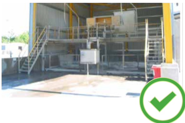
Kuva 5. Kuvassa liete valunut maastoon. Ylijäämäbetoni kuivatetaan kuivatustasolla ja toimitetaan luvalliseen kierrätyspaikkaan.
